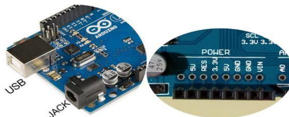
**Figura 4. Fuente de alimentación mediante USB o JACK**
