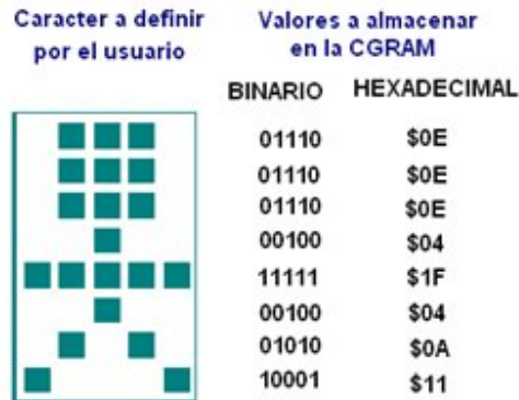
Fig. 14 Carácter definido por el usuario y los valores almacenados en la CGRAM
