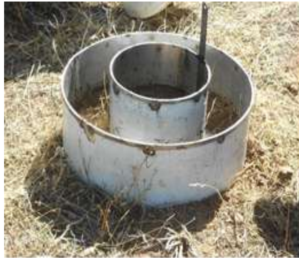
Figura 4. Prueba de infiltración con los anillos infiltrómetros
