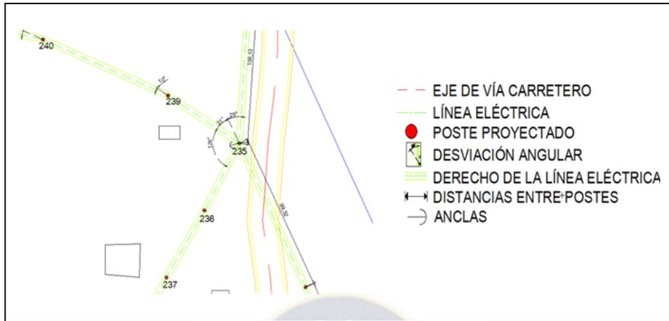
**Figura 25.** Ejemplo de las capas importantes en una línea eléctrica.
