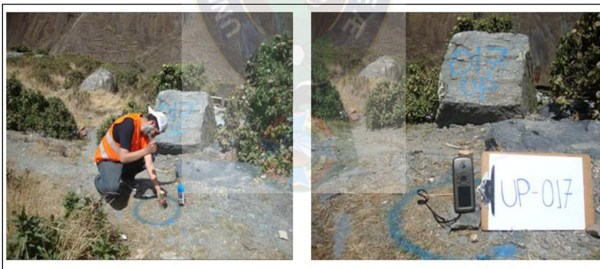
**Fotografía 8.** Toma de puntos GPS simulando un poste.
