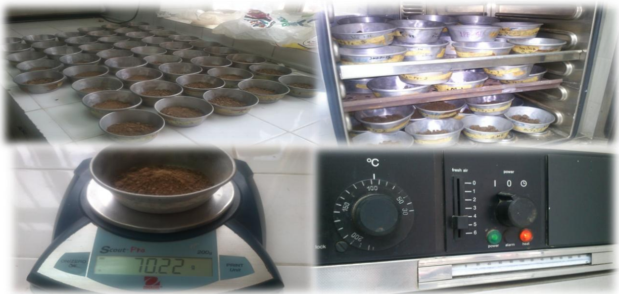
FOTOS 11 -12 - 13 - 14. Laboratorio de Suelos con el respectivo pesado de las 54 muestras de suelo para la variable humedad, llevados a la mufla por un lapso de 48 Hrs. a 105 °C de temperatura.
