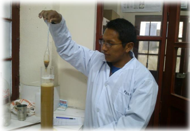
FOTOS 9 – 10. En laboratorio de suelos, lectura del densímetro para determinar textura para cada método de preparación del terreno.
