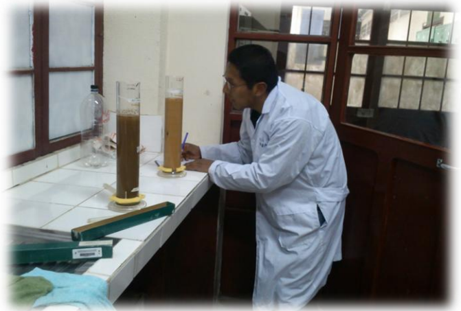
FOTOS 9 – 10. En laboratorio de suelos, lectura del densímetro para determinar textura para cada método de preparación del terreno.
