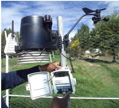
Foto 3. Instalación de estaciones meteorológicas
