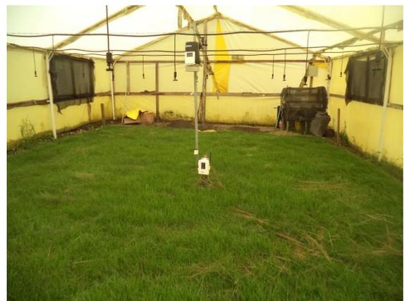
Foto 5, 6. Medición de la Evapotranspiración de referencia
