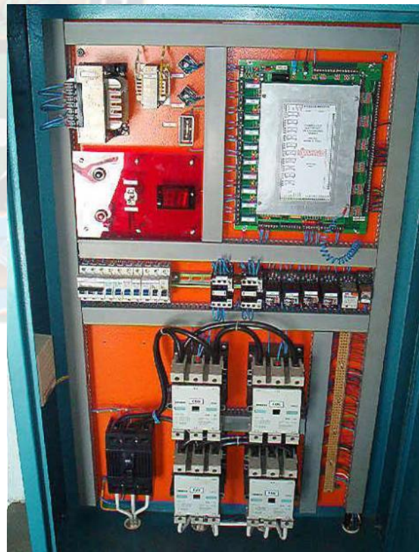
ESTRUCTURA INTERNA DE VARIADOR DE FRECUENCIA
