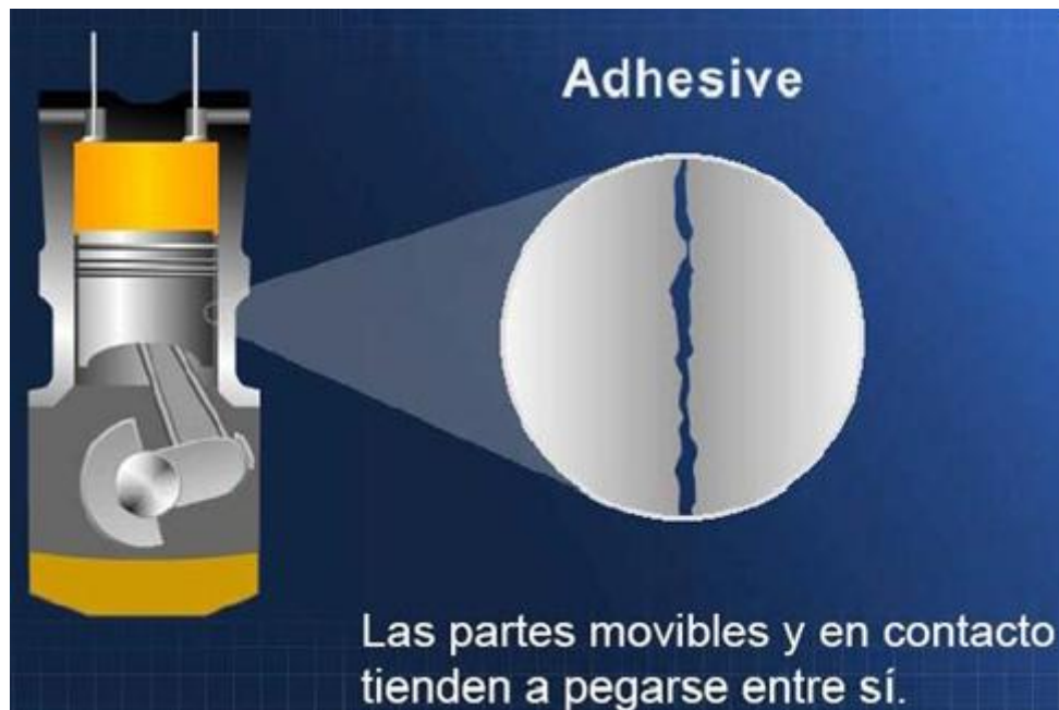
Figura 5: Desgaste de anillo y cilindro Fuente: http://lubricaciondemaquinaria.over-blog.es
