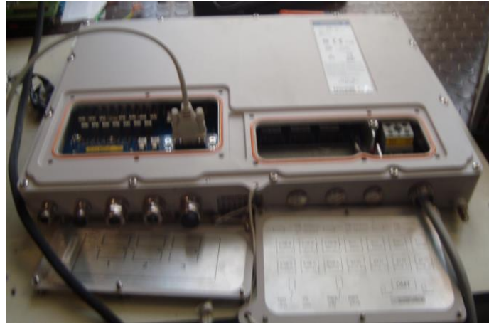
Figura 50. Interfaces de conexión de la MU (Fuente: Propia).
