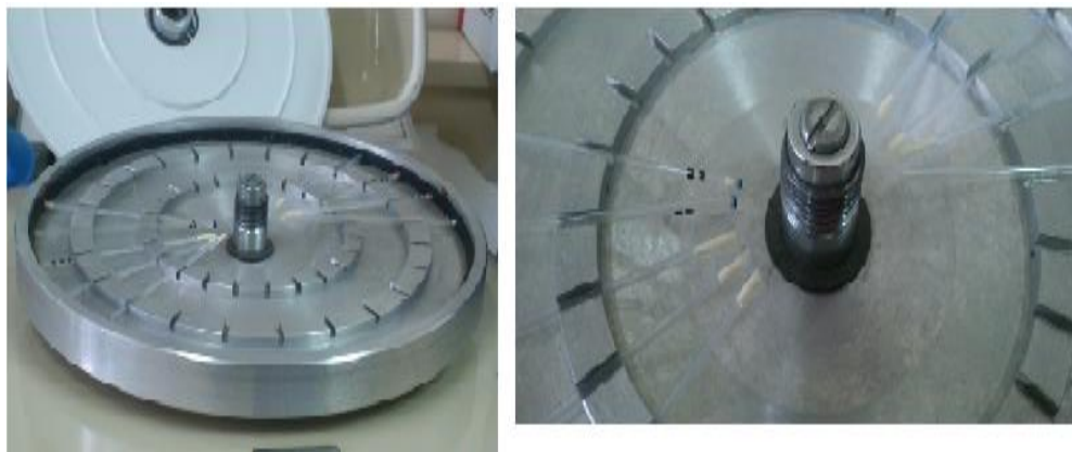
Figura 24. Centrifuga con tubos capilares con muestras de leche materna. Técnica del Crematocrito UCREDE 2014
