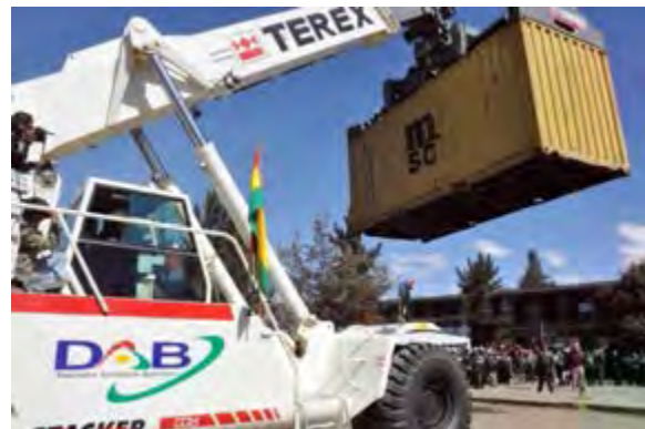
Fuente: Aduana Nacional de Bolivia La Grúa Portacontenedores TEREX TFC 45
