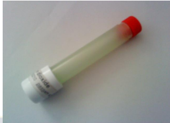
fig.9 Tubos pasivos de NO2 PASSAM (diámetro 9,5 mm, largo 7,4 cm)
