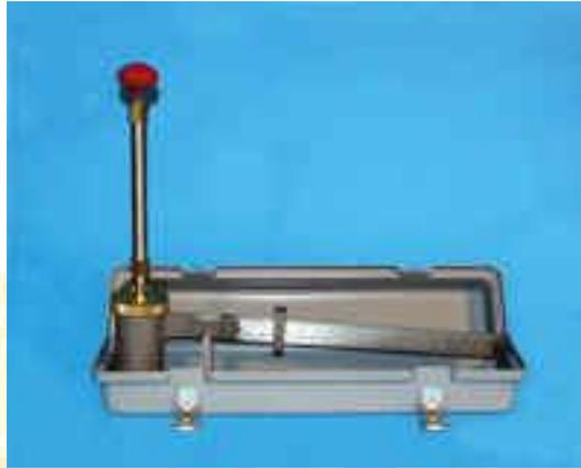
*Fig. c-2 Balanza presurizada montada*
