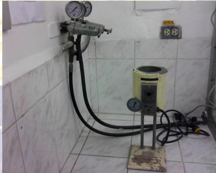
*Fig. e-3 Prensa filtro armada con conexiones de inyección de nitrógeno y accesorios
