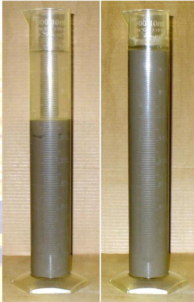
*Fig. g-3 Prueba de laboratorio de fluido libre*
