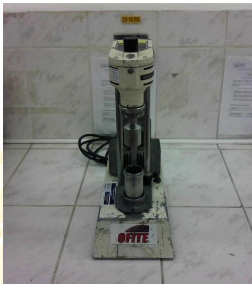
*Fig. d-3 Reómetro FANN 35
