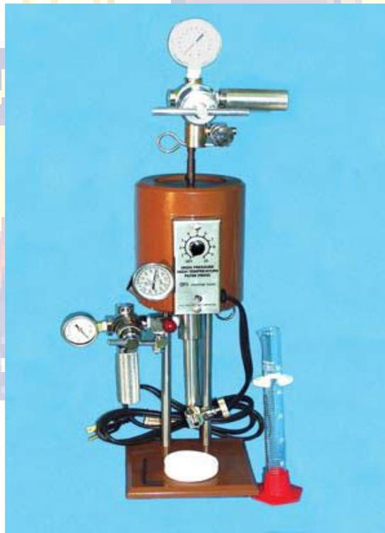
*Fig.e-2 Prensa filtro con accesorios
