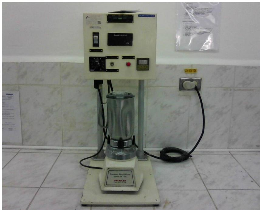
*Fig b-1 Blender o mezcladora marca Chandler
