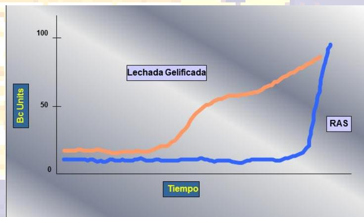
Fig. 19 Fraguado gelificado y fraguado en ángulo recto RAS
