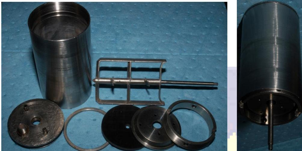
*Figs. f-1 a) Celda o capsula de contención de fluido desarmada (accesorios) b) Celda o capsula de contención de fluido armada*
