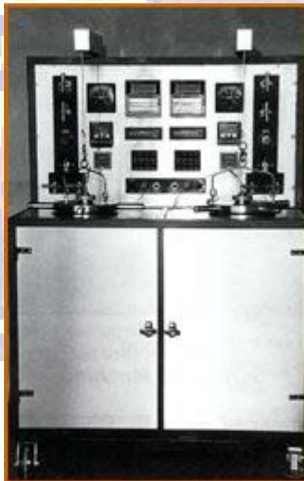
*Fig. f-2 Consistómetro presurizado (equipo)*
