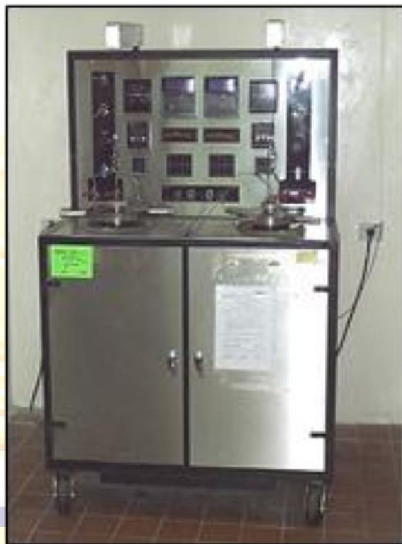
*Fig. d-1 Consistómetro presurizado (locación Bolivia)
