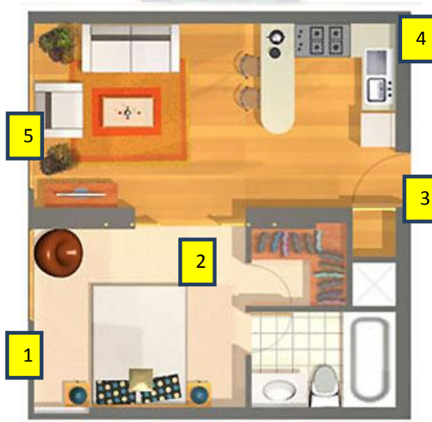
Figura 17 Distribución de sensores de Puertas y ventanas
