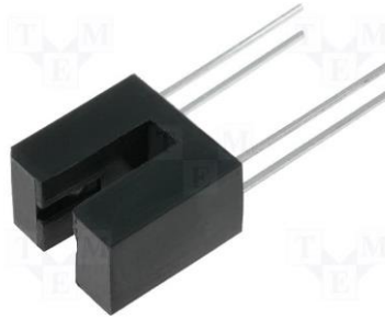
Fig. 7 Forma externa de optoacoplador en U
