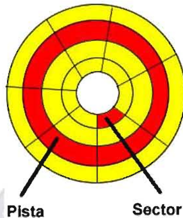
Figura 7: Diagrama de sectores y pistas de un plato de disco duro. Fuente: Elaboración propia.
