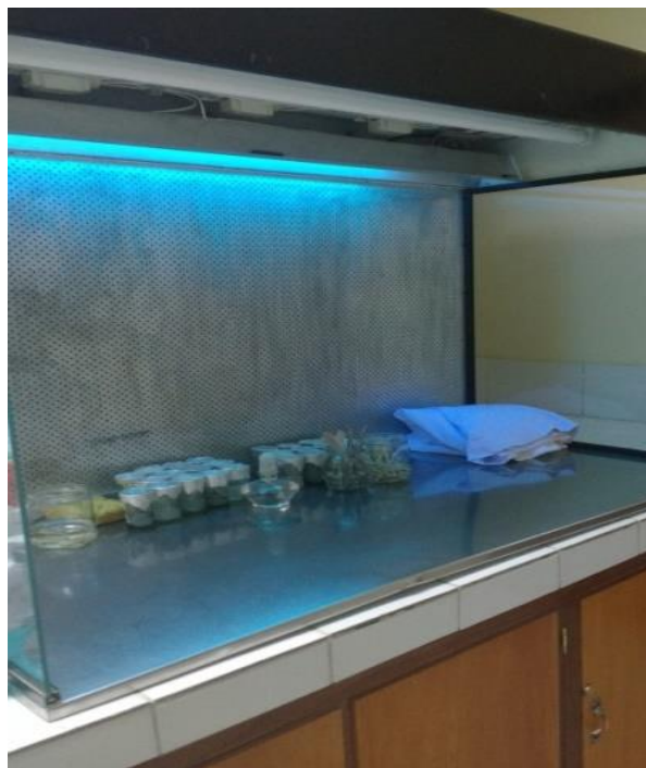
Anexo N° 8 Esterilizado de brotes con rayos ultravioleta
