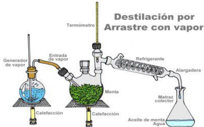
Figura 3. Destilación por arrastre de vapor
