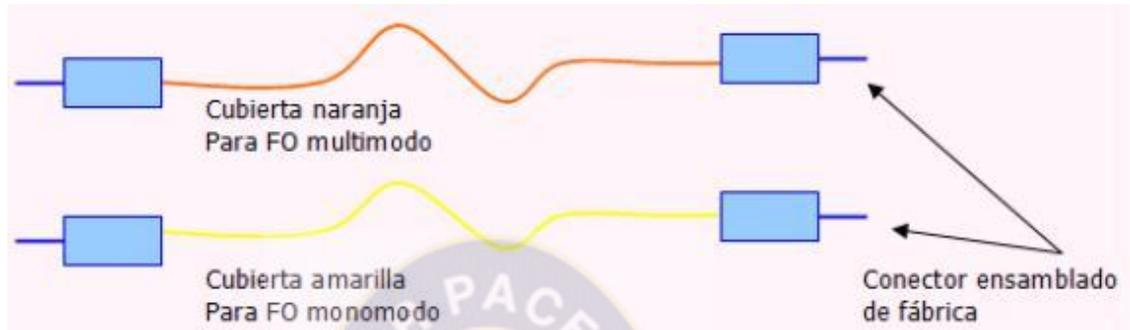
**Figura 20. Latiguillo de conexión**
