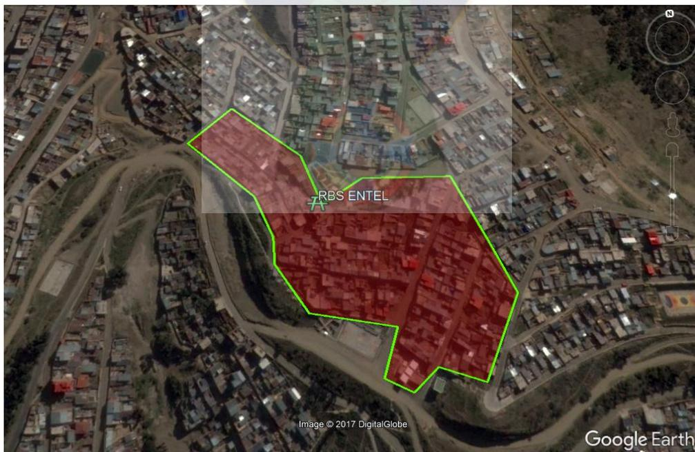
Para el escenario planteado se efectuará el diseño de la red FTTH tomando como proveedor de los servicios a la empresa de telecomunicaciones ENTEL, cuya TROBA (Terminal de Red Óptica de Banda Ancha) se encuentra ubicado en la dirección av. Chacaltaya entre bolívar calle paralela con sus coordenadas  $16^{\circ}29'3.79''S$ ,  $68^{\circ}10'9.17''O$
