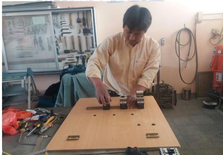
Figura #29 colocado de piezas contactor
