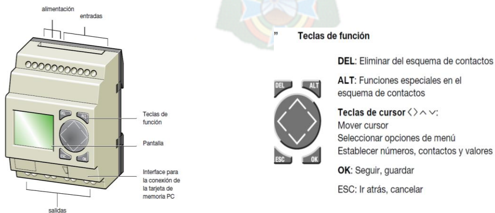
Figura #22 Partes del PLC easy
