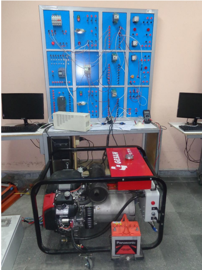
Figura #3 foto tablero para el sistema de control del grupo electrógeno Mediante PLC.
