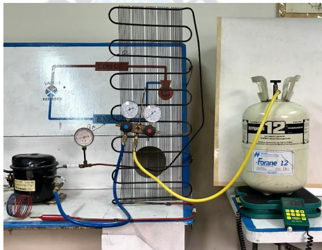
IMAGEN 8: Carga de refrigerante Fuente: Elaboración propia
