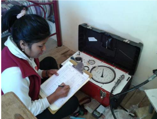
Toma de datos del potencial hídrico de la planta obtenido en la cama scholander.
