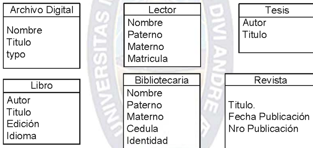
Fig 3.3 Diagrama de clases con atributos.
