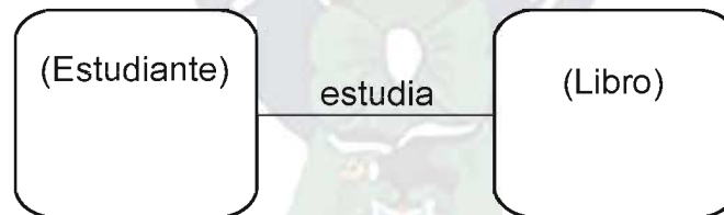
Fig 2.7 Notación para diagrama de objetos conteniendo una liga.
