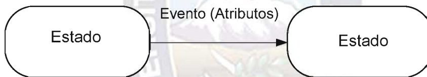
Fig 2.18 Notación para un evento con atributos causando una transición entre dos estados.
