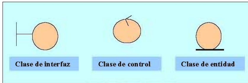
Figura 2.6 Estereotipos de UML
