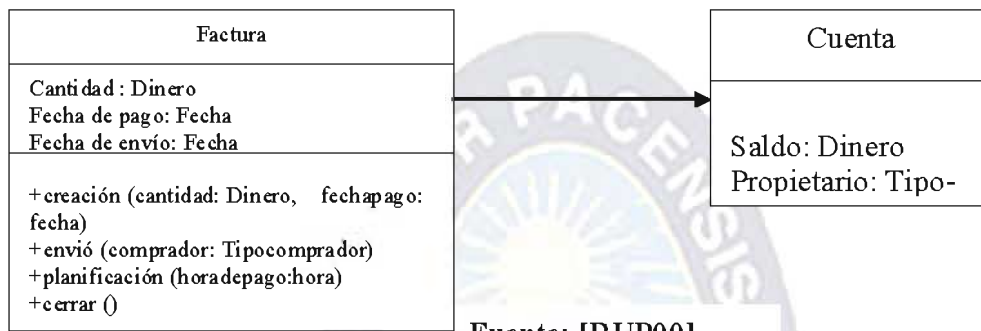
Figura 2.9 la clase de diseño ejemplo factura con sus atributos
