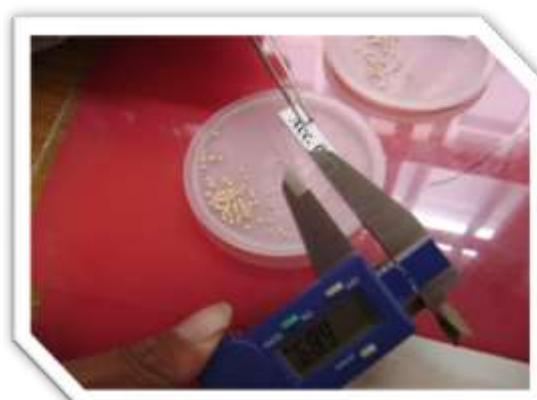
Fot. 4. Evaluación del diámetro de grano con el vernier digital
