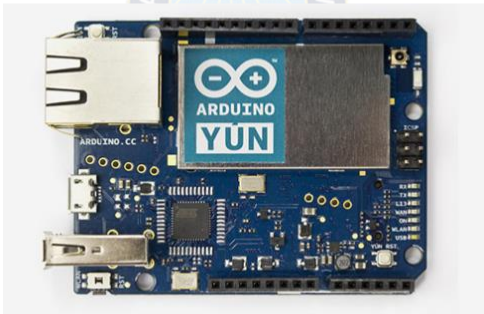
Figura 2.2 Arduino Yun (extraído de la página oficial de arduino www.arduino.org )
