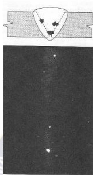
Figura 22: Inclusiones de tungsteno
