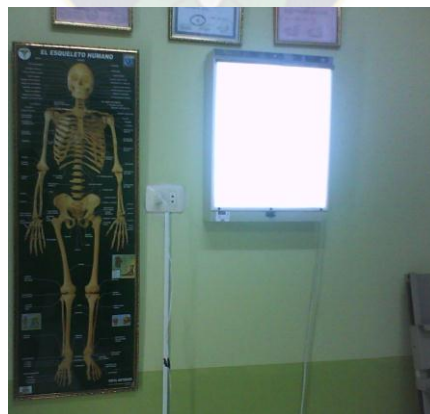
Figura N° 29 Negatoscopio instrumento utilizado para observar las placas radiográficas
