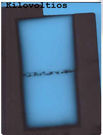
Figura N° 41 radiografía con parámetros de tiempo 1/2 segundos, 88
