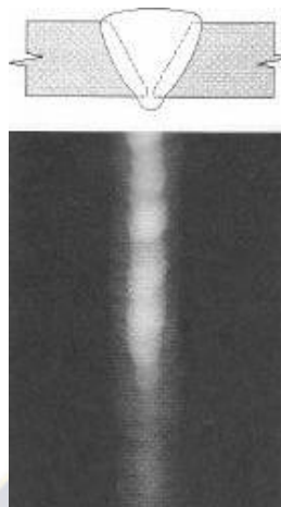
Figura 6: Exceso de penetración.
