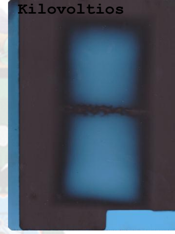
Figura N° 42 radiografía con parámetros de tiempo 1 segundos, 110 Kilovoltios
