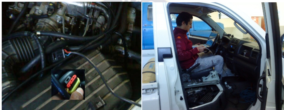
Figura 44.- Toma de diagnóstico e interface del funcionamiento con la computadora del motor Suzuki Carry convertido a GNC
