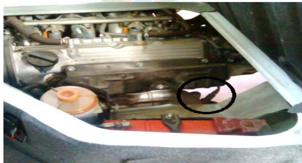
Figura 43.- Señal de la sonda lambda
