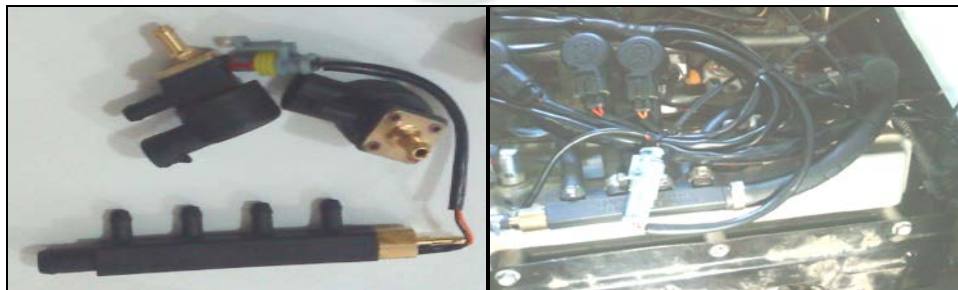
Figura 27.- Instalación de riel de inyectores RRDM/6 E 13 110R0001113 en el motor Suzuki
