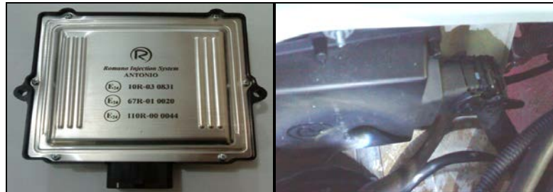
Figura 33.- Centralita de kit de conversión GNC y su instalación en vehículo
