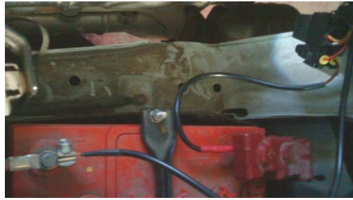
Figura 38.- Alimentación del kit de inyección secuencial GNC.
