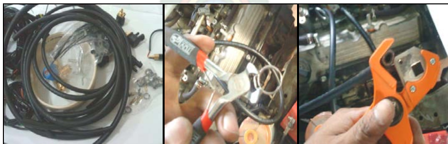
Figura 29.- Mangueras de goma, en corte por herramienta y ajuste de seguros en terminales
