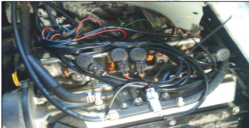
Figura 37.- Conexión de las electroválvulas en el motor Suzuki Carry
