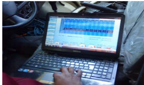
Figura. 47.- Mapeo de corrección de inyección a GNC
