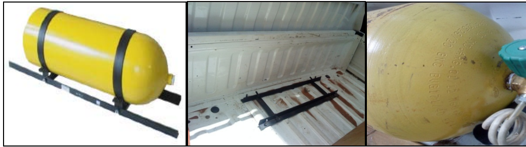
Figura 21.- Instalación del cilindro y cuna en el vehículo Suzuki Carry de ensayo
