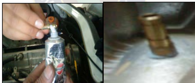
Figura 32.- Roscado del con herramienta, pegado con el sellador la boquilla en múltiple admisión
