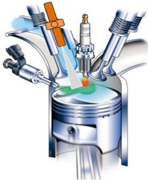
Figura 61.- Reducción del área de circulación en el colector de admisión por la influencia de los dos inyectores, de gasolina y de GNC.
