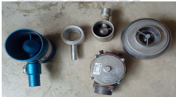
Figura 02.- Tipos de mezcladores convencionales y de turbina (Gentileza del IIME-UMSA)
