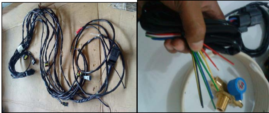
Figura 34.- Cableado del sistema de conversión GNC de 5ta generación
