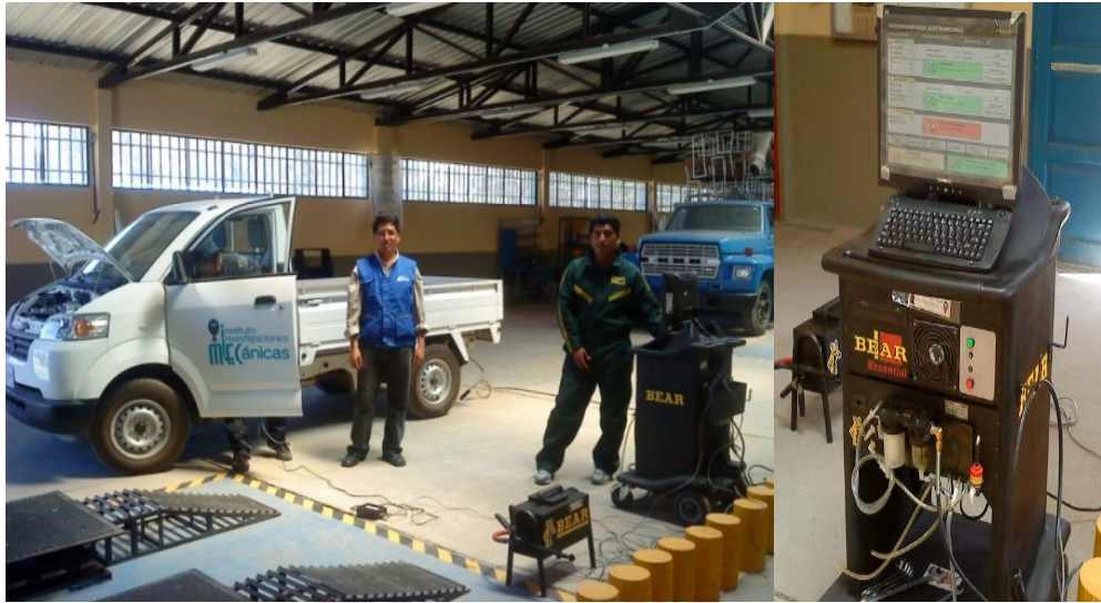
Figura 57.- Analizador de gases de escape BEAR BE-140 instalado en vehículo Suzuki Carry
