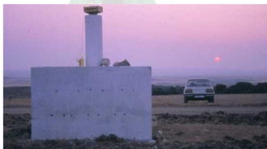
Con el método diferencial se eliminan muchos de los errores propios de la observación GPS (retardo ionosférica, retardo troposférico, error en efemérides, error del reloj del satélite).
