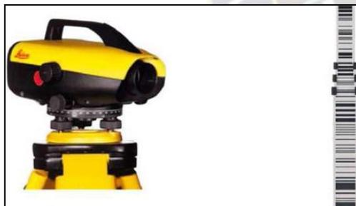
Cada vez más se utilizan niveles automáticos y de LECTURA AUTOMÁTICA. Con ellos en vez de utilizar una mira dividida en milímetros o dobles milímetros, se utiliza una con una especie de código de barras, que es capaz de interpretar el sensor de imagen
