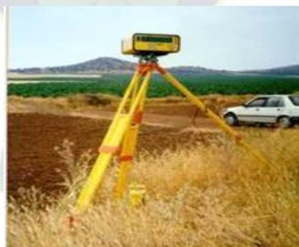
**Segmento Usuario:** compuesto por un conjunto de aparatos que sirven para recibir y almacenar la señal emitida por los satélites y calcular en base a estos datos la posición en la que nos encontramos. Se compone de varios elementos, entre los que destacan la antena, el receptor y el terminal o unidad de control. A través de la antena se reciben
