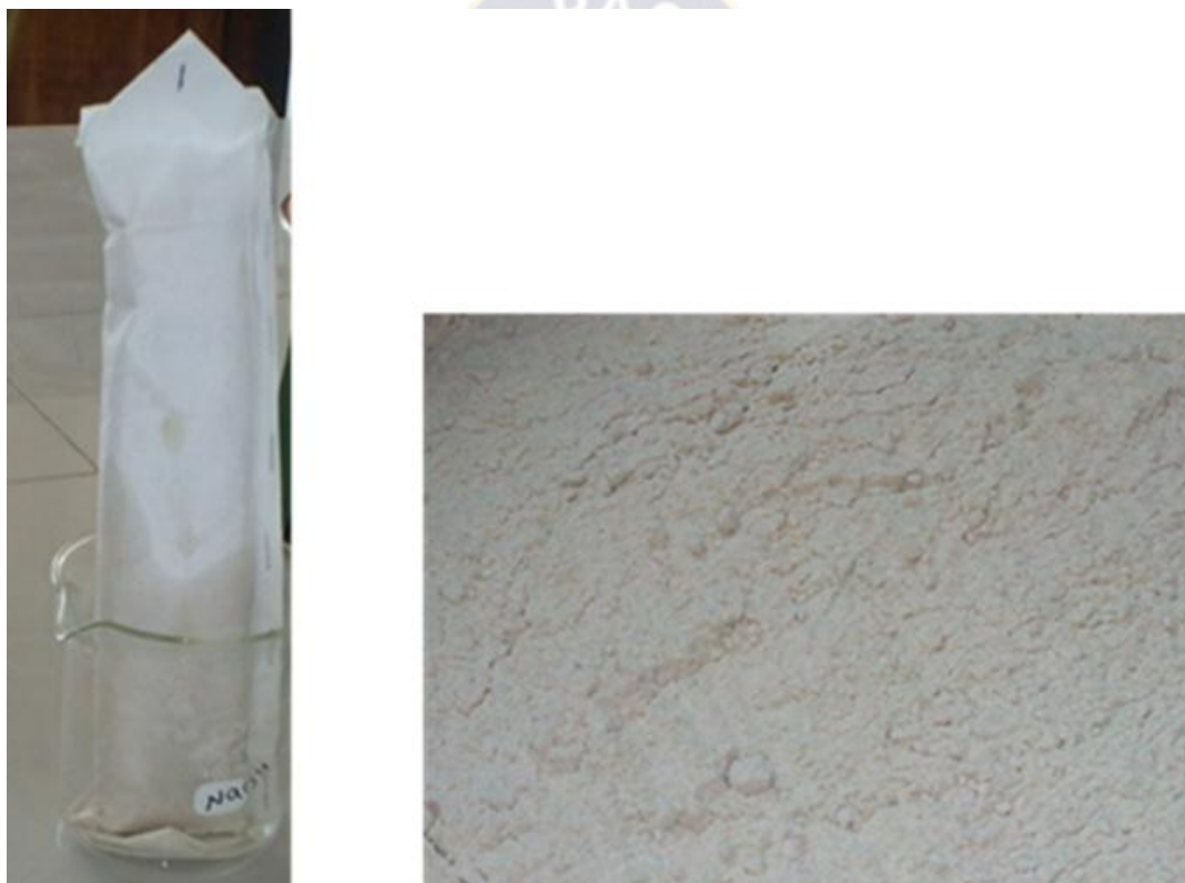
Figura 34: Extracción del aceite; harina desgrasada de amaranto
