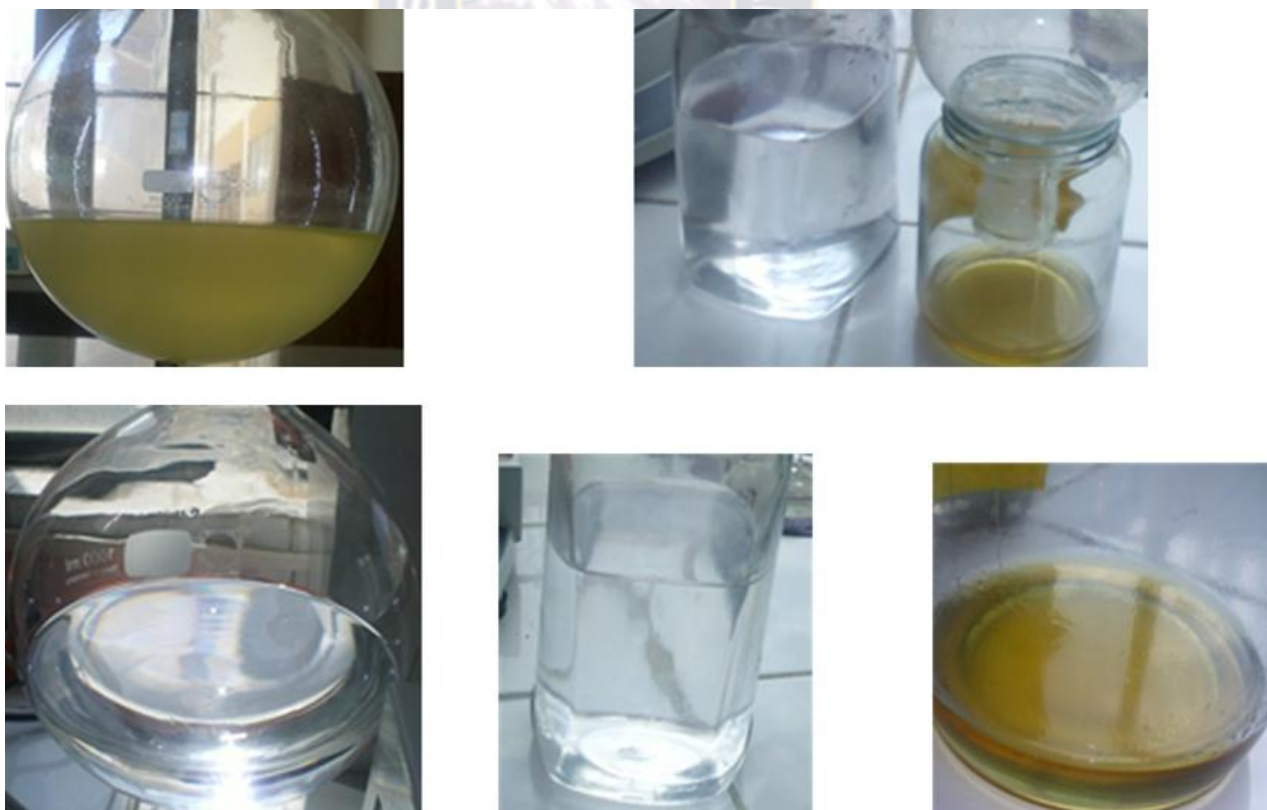
Figura 36: Rotaevaporación; hexano y aceite de amaranto
