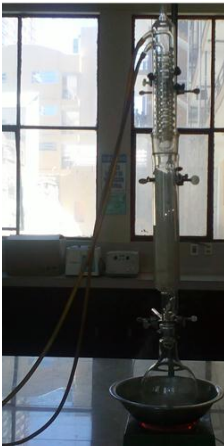
Figura 53: Extracción del aceite de amaranto ( Amaranthus caudatus ) variedad Oscar Blanco mediante Equipo SOXHLET
