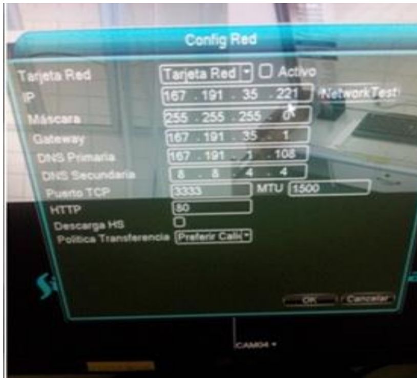
Figura N°4.51 Ventana para la configuración de red en el DVR Fuente : fotografía tomada por el autor, de un DVR PANTER
