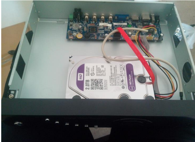
Figura N°4.48 DVR de 4CH marca COF
