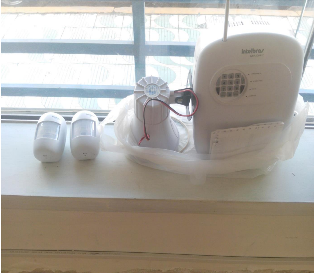
Figura N°2.1 Sistema de alarma BRASBOL
