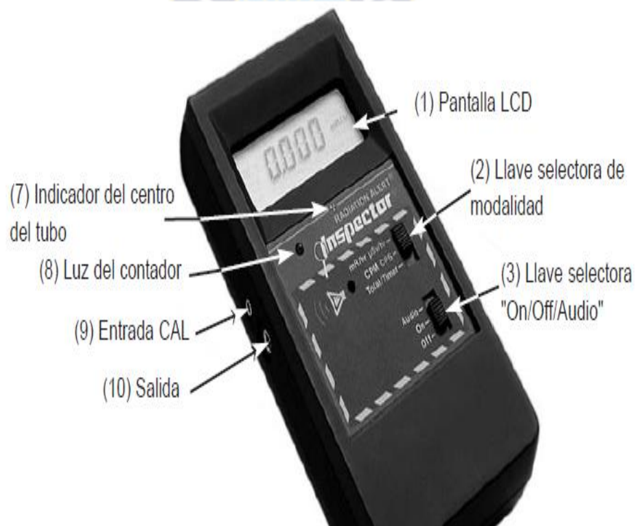
Figura 2.5 Características del monitor portátil Inspector+.
