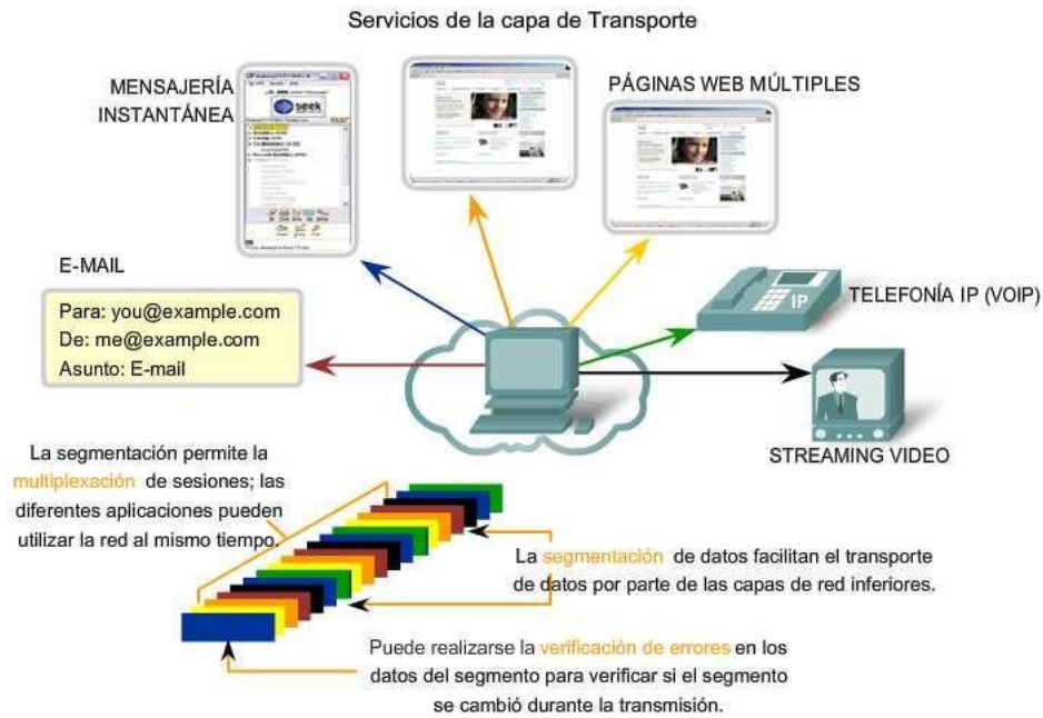
Figura 2.19 Fragmentación de datos en la capa de transporte
