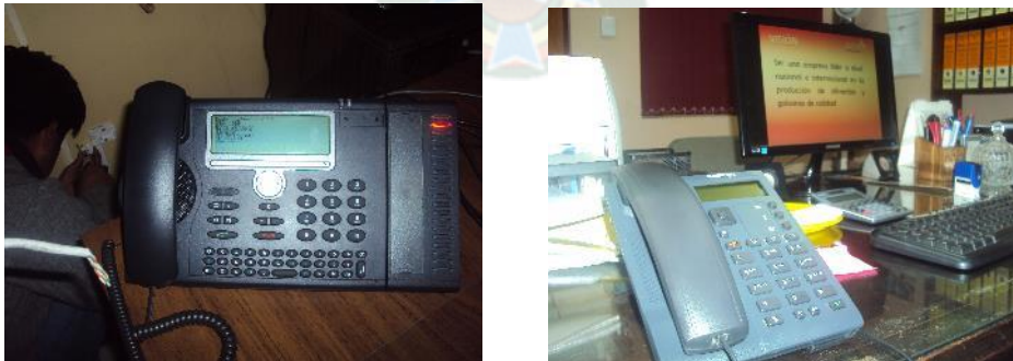
Figura 3.23 Teléfono IP para operador y teléfono para usuario
