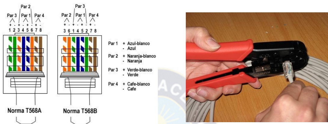
Figura 3.10 Crimpado de un conector RJ45 con norma A o B
