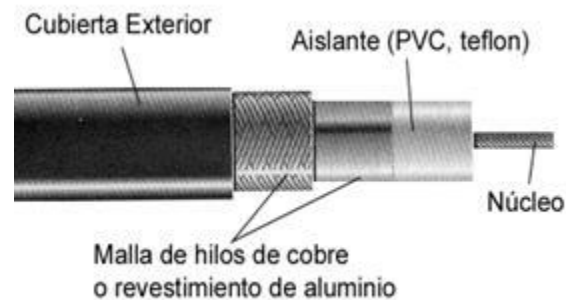
Figura 2.9 Partes de un cable coaxial
