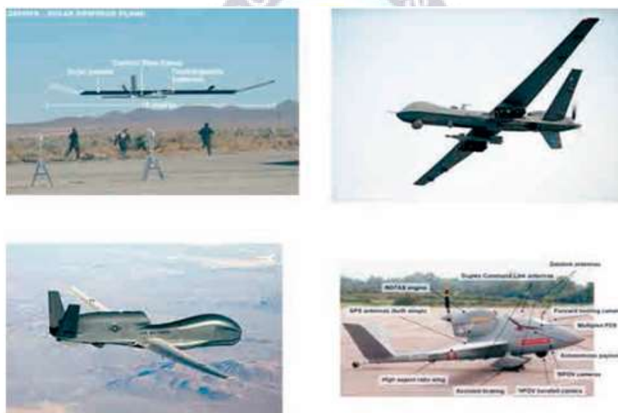
Sistemas no tripulados de ala fija más relevantes en la década de los 90. De izquierda a derecha y de arriba abajo, el Zephyr, el Predator A, el Global Hawk y el Herti.
