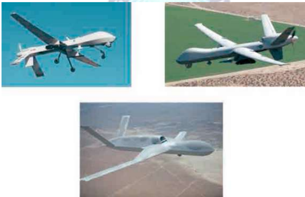
Evolución seguida por los diferentes modelos del UAS Predator . De izquierda a derecha y de arriba abajo, modelos A, B y C.
