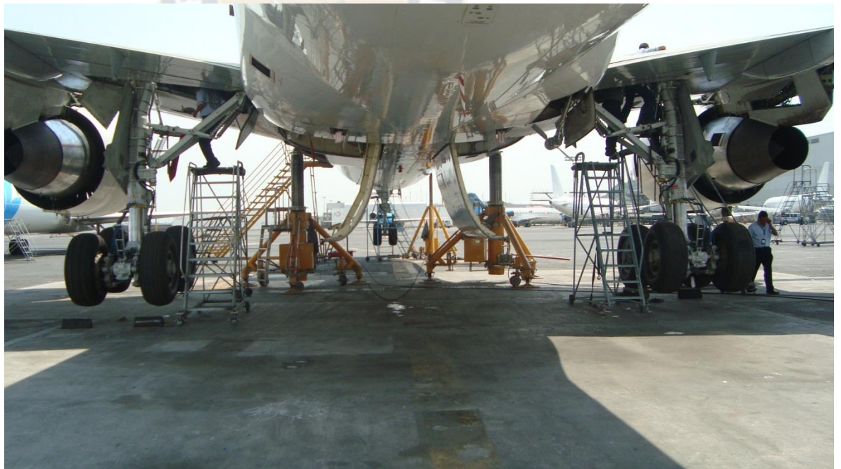
Imagen 4: Inspección en rampa y verificación de plegado de trenes
