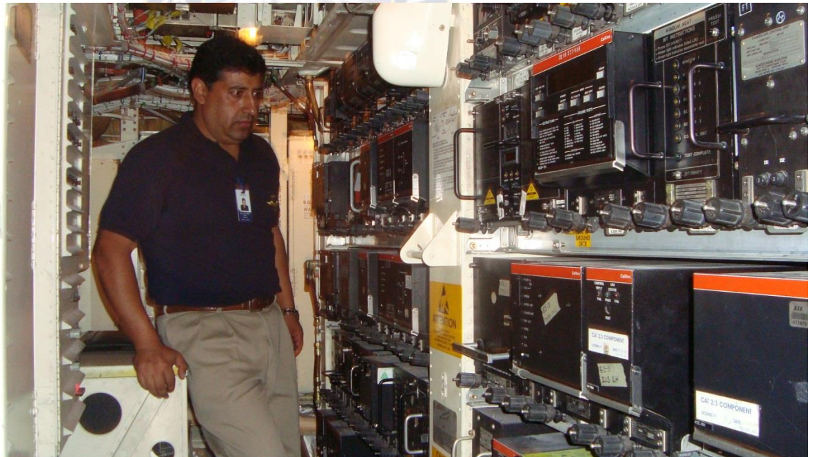
Imagen 2: Inspección para verificar componentes de aviónica que coinciden con la documentación presentada
