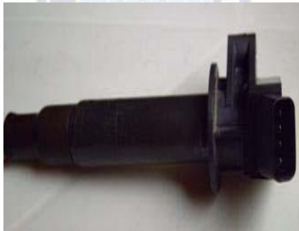
Gráfico N° 11 Bobina COP con módulo incorporado
