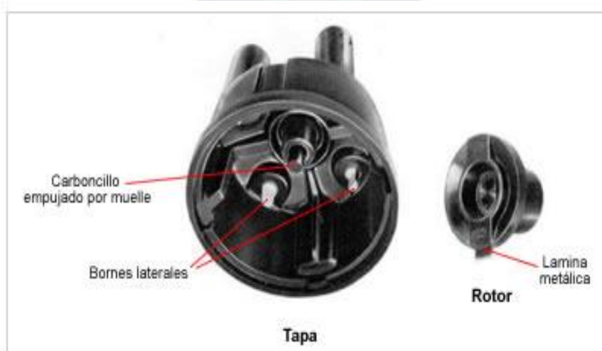
Gráfico N° 3 Tapa y rotor del distribuidor
