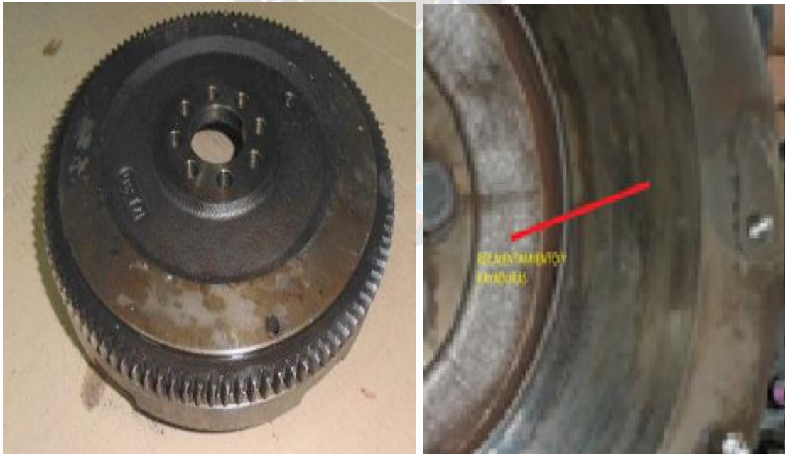
FOTOGRAFIA 2.3 BOLANTE DE INERCIA (ralladura y recalentamiento en el apoyo del plato opresor)
