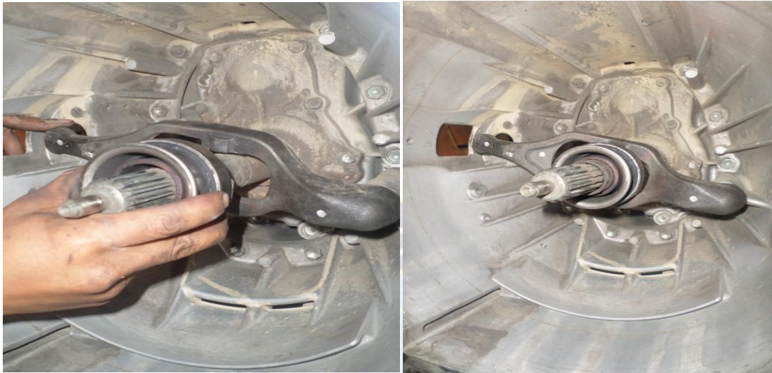
Fotografía N° 22 Montaje del Rodamiento Desplazador y la Horquilla
