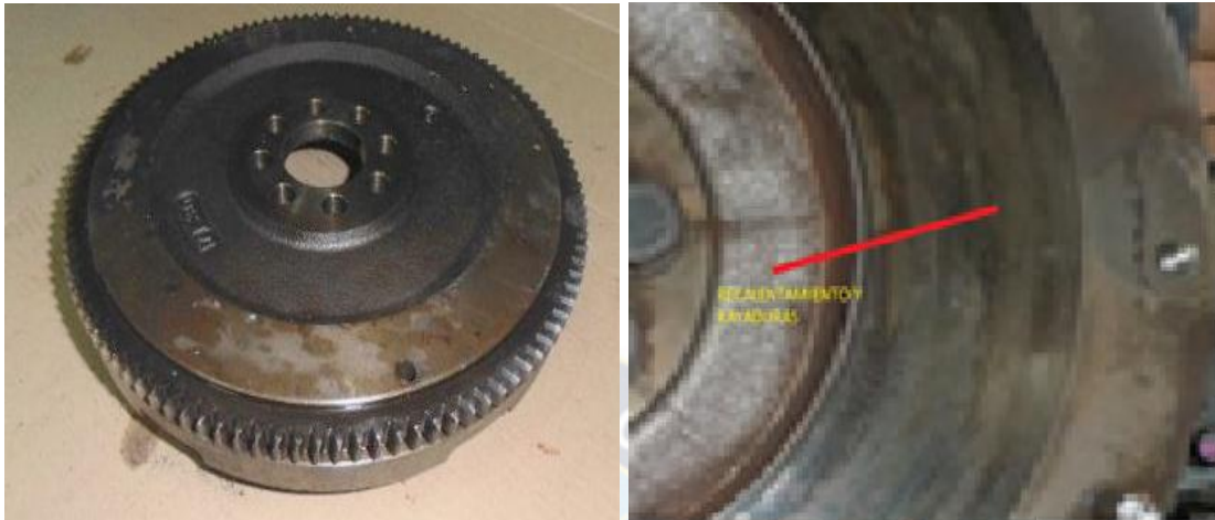
Fotografía N° 14: Desgaste y Recalentamiento del Volante de Inercia
