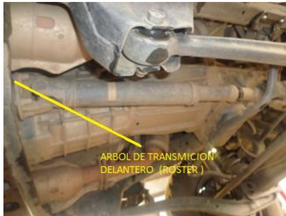
Fotografía N° 5: Desmontaje del Árbol de Transmisión Anterior
