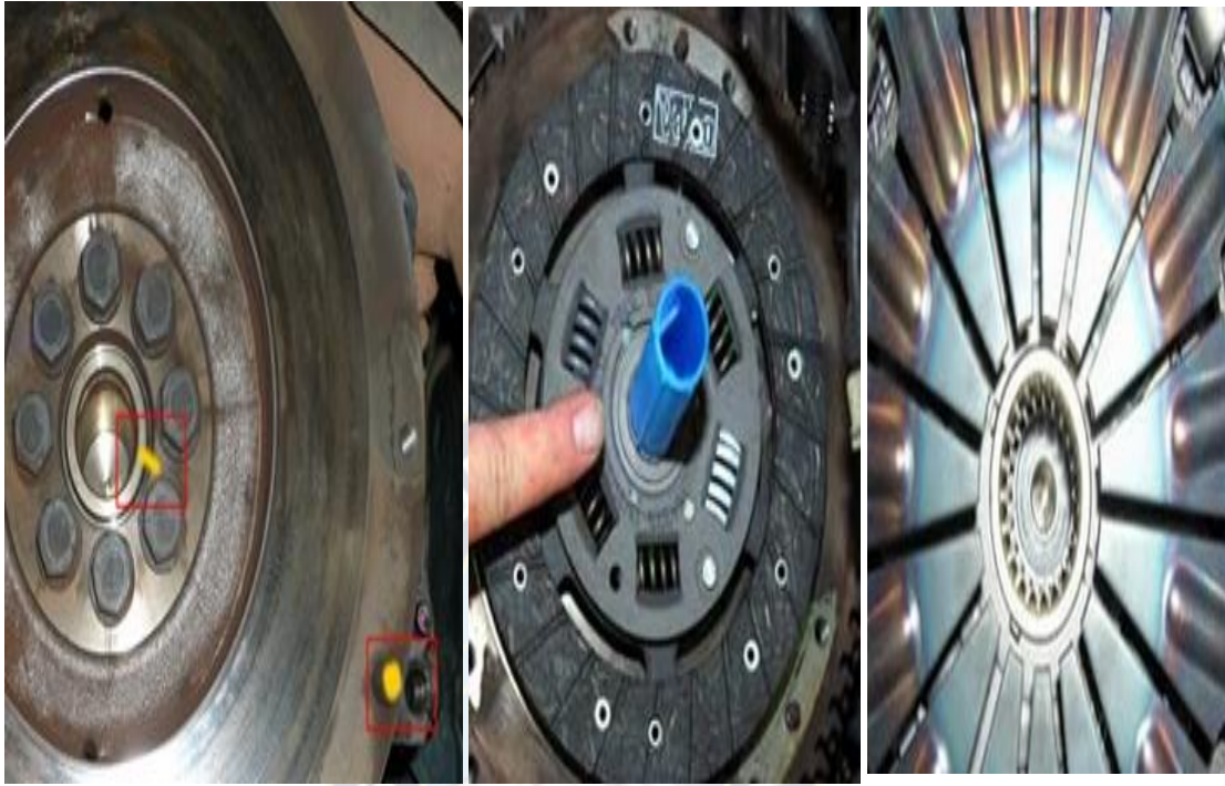
FOTOGRAFIA N° 2.4 SENTREADO DEL DISCO DE EMBRAGUE Y PLATO OPRESOR DE EMBRAGUE
