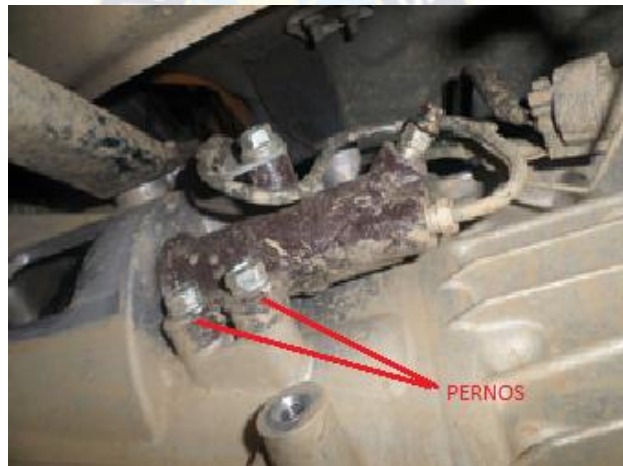
Fotografía N° 7 Desmontaje del Cilindro Accionamiento
