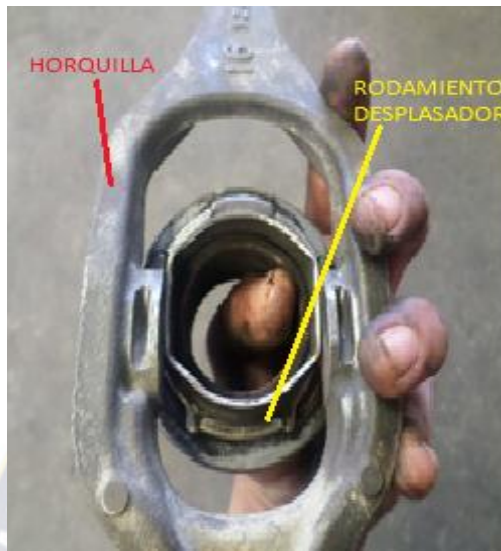
Fotografía N° 12: Desmontaje del Rodamiento Desplazador y Horquilla
