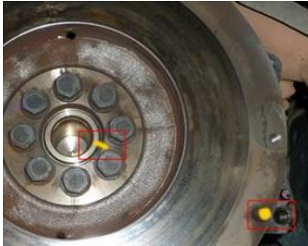
Fotografía N° 20: Desmontaje del Volante de Inercia
