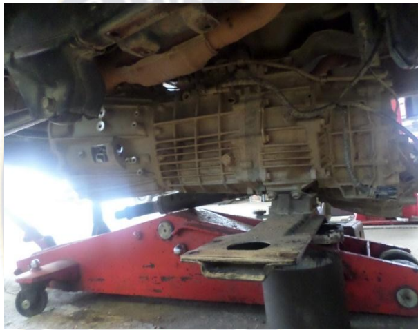
Fotografía N° 9: Desmontaje de la Caja de Velocidades
