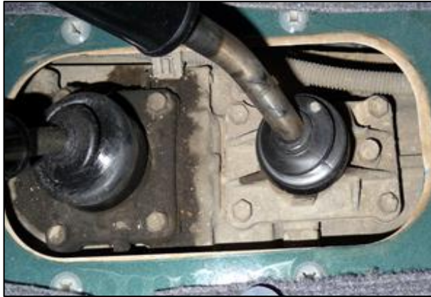
Fotografía N° 2 Desmontaje de los Bastones de Cambio
