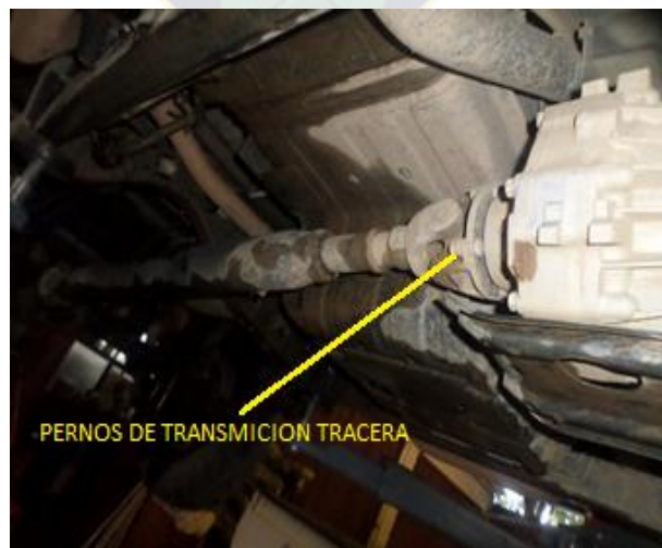
Fotografía N°4: Desmontaje del Árbol de Transmisión Posterior
