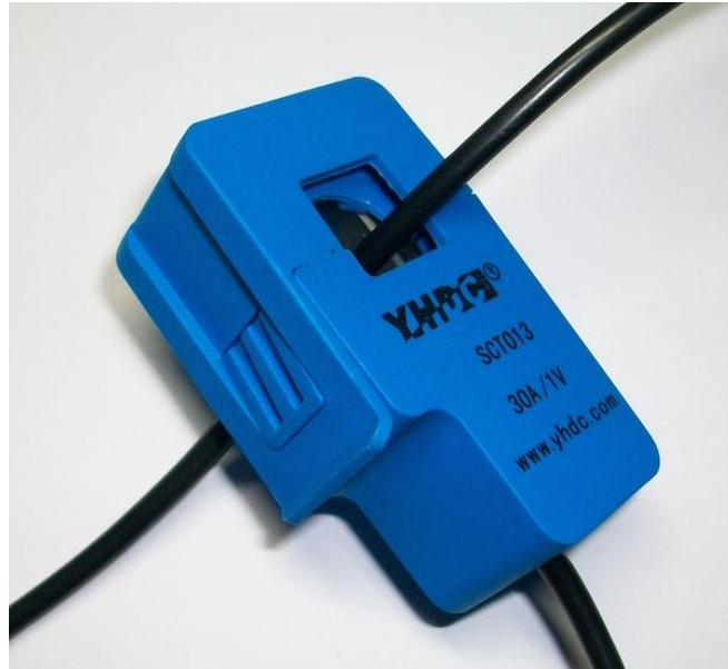
Figura N° 15 Forma de realizar la medición con sensor de corriente SCT013
