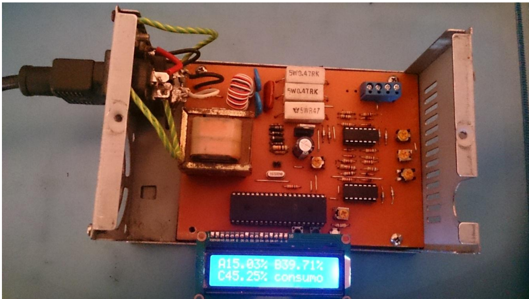
Figura N° 20 Funcionamiento de circuito de medición de consumo de energía
