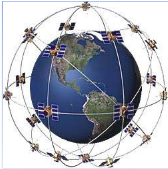
Figura Nro. 4 El segmento espacial GPS y su distribución.
