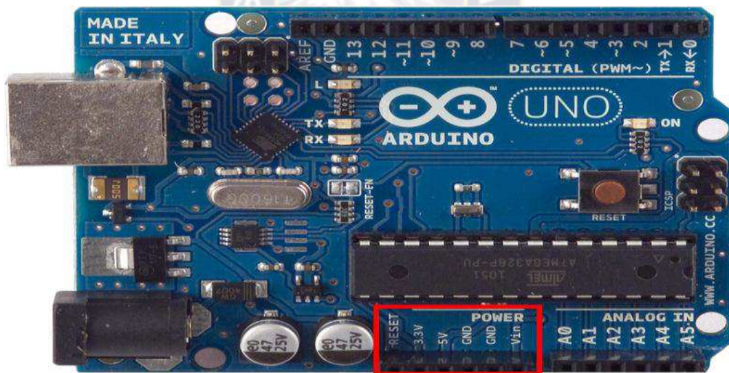
FIGURA 12. PINES DE ALIMENTACION DE TARJETA ARDUINO Fuente. Universidad de Cádiz
