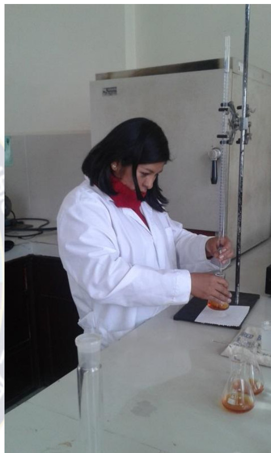
Foto No 6 TITULACIÓN DE LA MUESTRA
