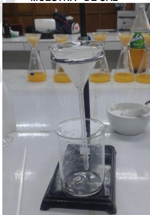
Foto No 4 FILTRADO DE LA MUESTRA DE SAL
