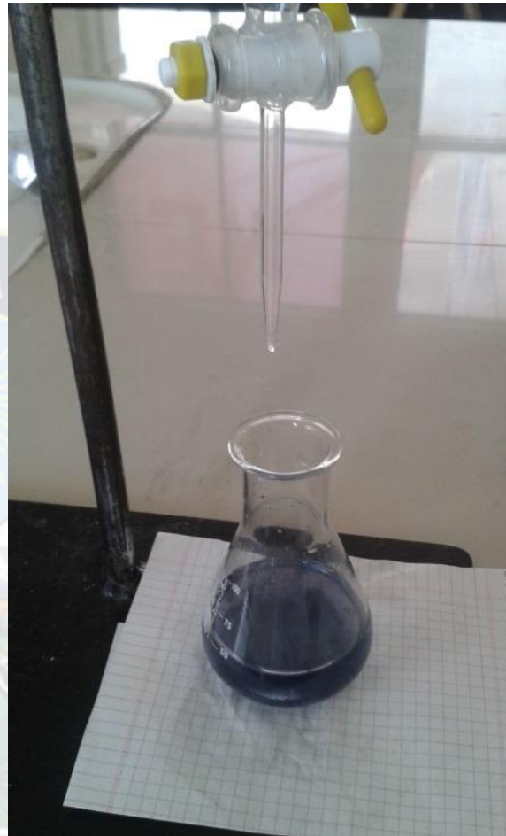
Foto No 8 CAMBIO DE LA SOLUCIÓN A COLOR AZUL
