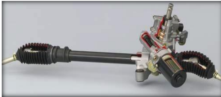
Figura 26. Dirección asistida EPS con montaje sobre el piñón
