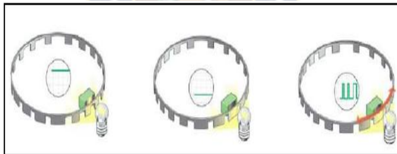
Figura 31. Principio de funcionamiento del sensor de ángulo de dirección
