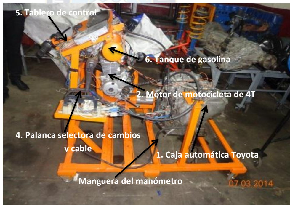
Fig.46 Equipo didáctico para medir La Presión en Línea de Una Transmisión Automática Trasversal.
