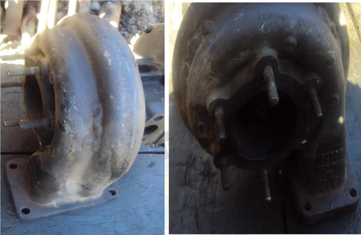
**Foto N° 2.3 CAROCOL DE ESCAPE (recolecta los gases de escape del motor y lo dirige hacia la rueda de la turbina)**
