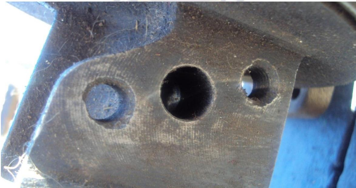
**Foto N° 2.6 ENTRADA DE ACEITE (orificio para que el turbo alimentador reciba el aceite limpio que lubricara todos los elementos rotativos en el interior del cuerpo central)**
