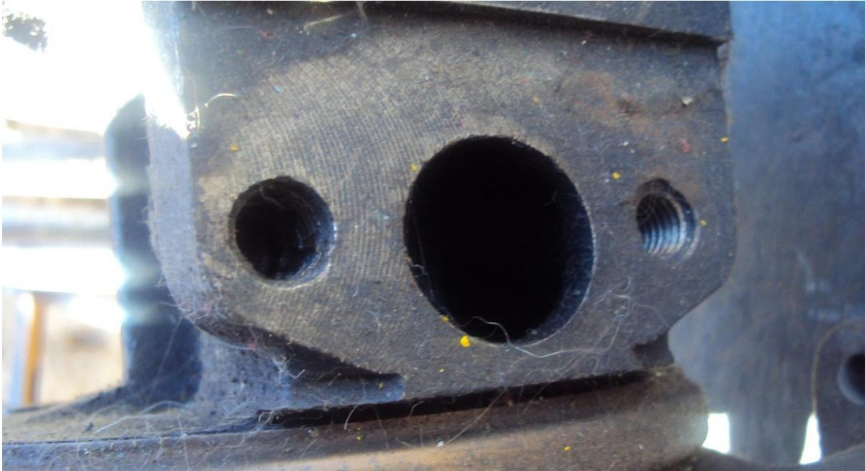
**Foto N° 2.7 SALIDA DEL ACEITE (orificio que permite el retorno del aceite que ha lubricado los elementos rotativos del cuerpo central del turbo alimentador)**
