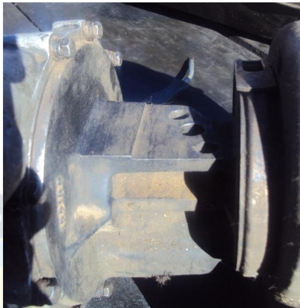
**Foto N° 2.5 CUERPO CENTRAL (Contiene al conjunto de elementos rotativos del turbo alimentador)**
