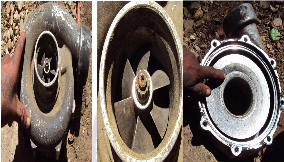
**Foto N° 2.1 CARCASA COMPRESORA (recolecta aire comprimido y lo direcciona al múltiple de admisión del motor)**
