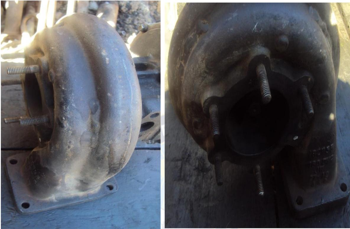
**Foto N° 2.3 CAROCOL DE ESCAPE (recolecta los gases de escape del motor y lo dirige hacia la rueda de la turbina)**
