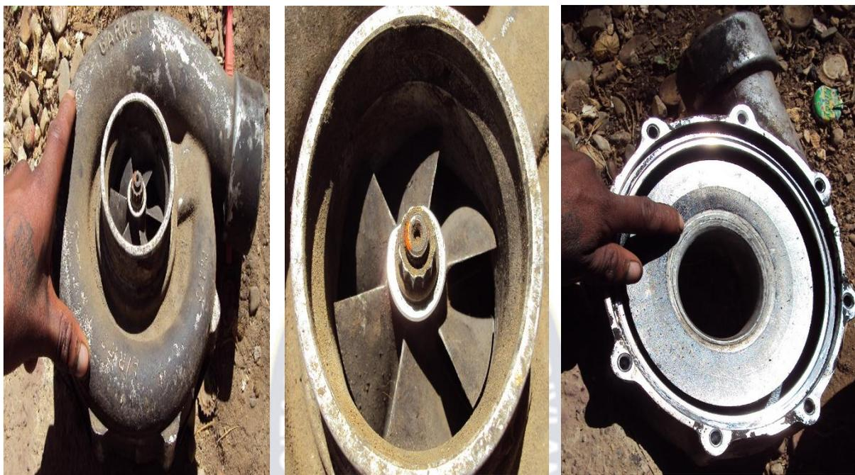
**Foto N° 2.1 CARCASA COMPRESORA (recolecta aire comprimido y lo direcciona al múltiple de admisión del motor)**
