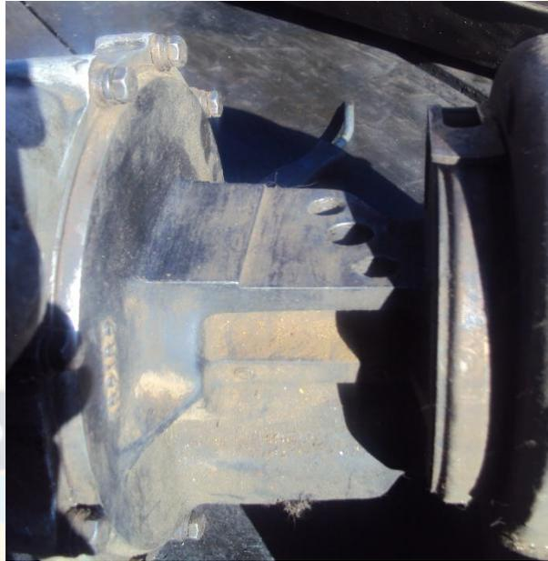
**Foto N° 2.5 CUERPO CENTRAL (Contiene al conjunto de elementos rotativos del turbo alimentador)**
