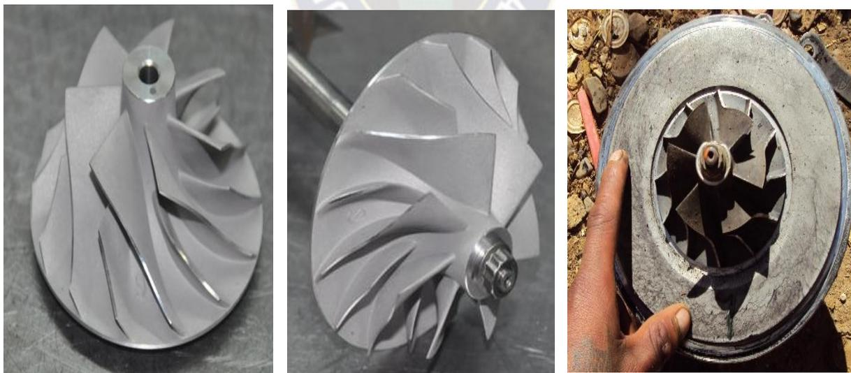
**Foto N° 2.2 RUEDA COMPRESORA (rueda cuyo diseño al girar aspira aire del ambiente y lo envía hacia el múltiple de admisión del motor)**
