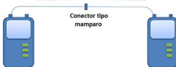
Fig.9. Los conjuntos de testeo deben estar referenciados antes de las mediciones
