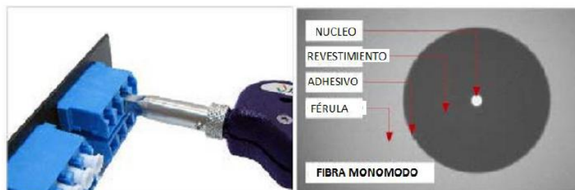
Fig. 6. Inspección del conector tipo mamparo ó de conector a través del adaptador.
