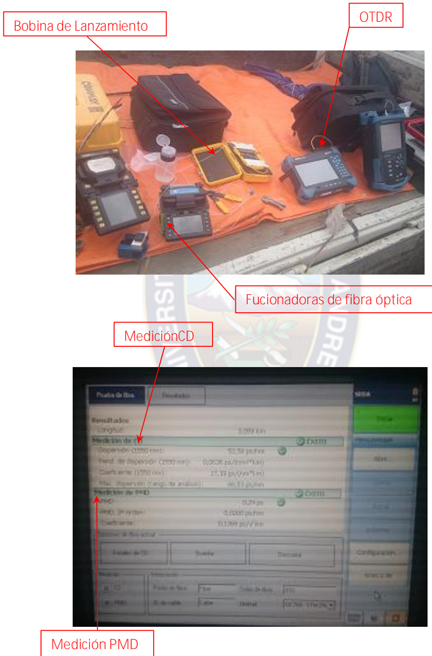
Figura 26. Medición de la dispersión por modo de polarización (PMD)
