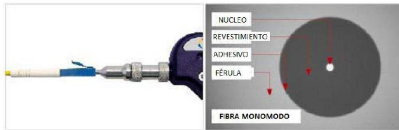
Fig.5. Inspección del patchcord
