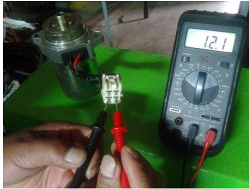
Fig.60. Pruebas con la resistencia en B3 y B4 en ohmios del embrague según el manual.
