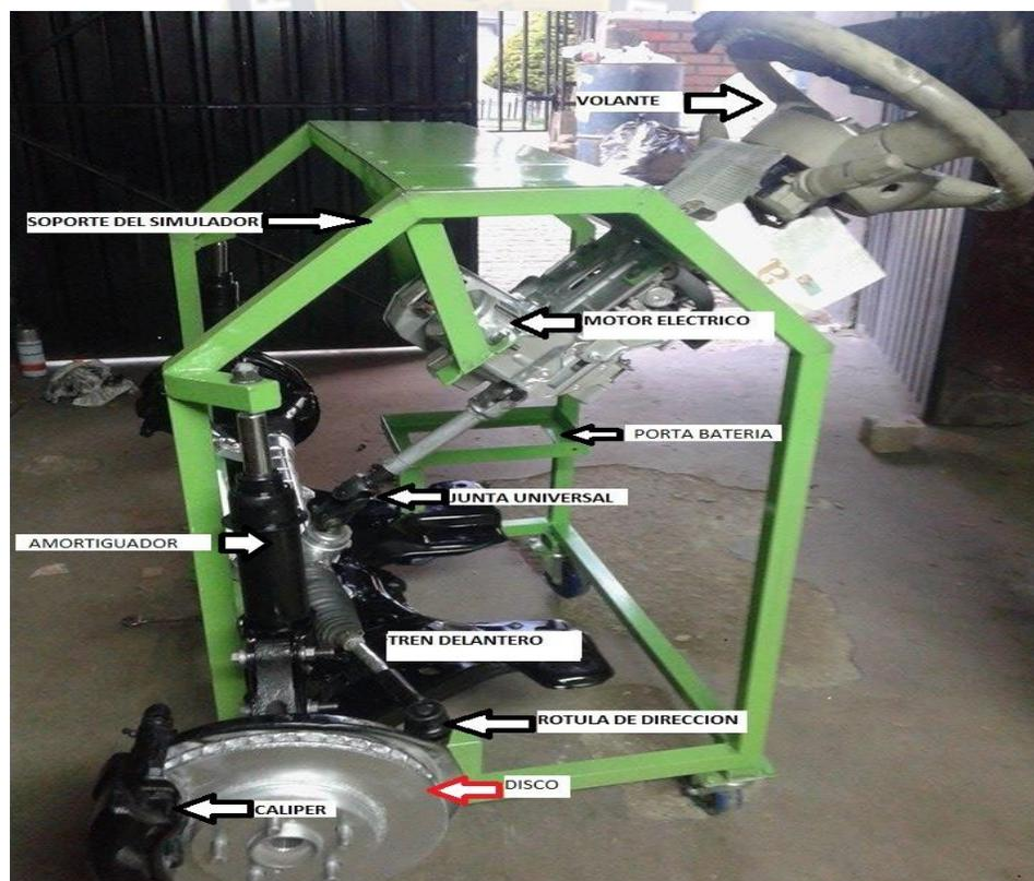
Fig. 54. Montaje de la parte mecánica y electrónica en el simulador de dirección EPS.
