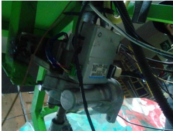
*Fig. 51. Unidad de control para la dirección Electrical Powered Steering (EPSCM).*
