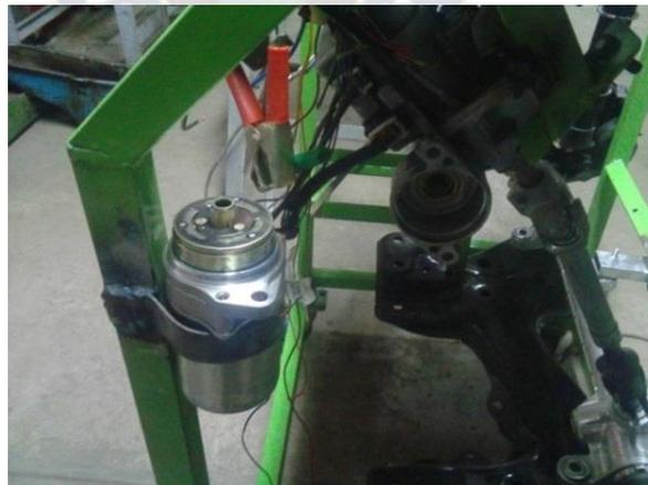
*Fig.50. Motor eléctrico separado de la columna para poder apreciar la asistencia.*
