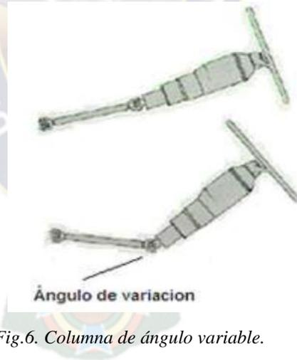
Fig.6. Columna de ángulo variable.
