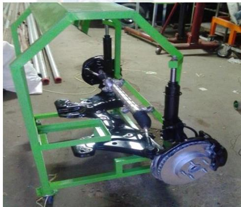
Fig.48. Tren delantero de un sistema de dirección asistido electrónicamente incorporado al simulador.
