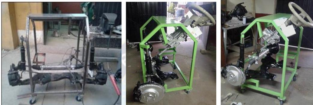
Fig. 53. Estructura del simulador de dirección EPS.
