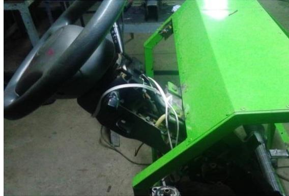
*Fig.49. Sensor de par de dirección.*
