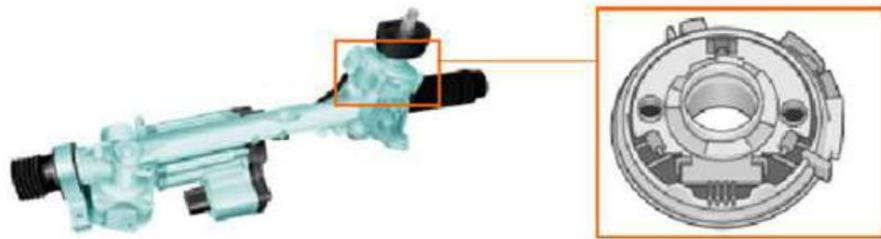
Fig. 31. Sensor de par de dirección.
