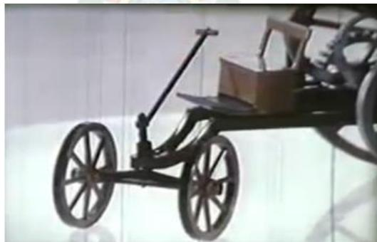
*Fig.2. Sistema de dirección de un solo eje.*
