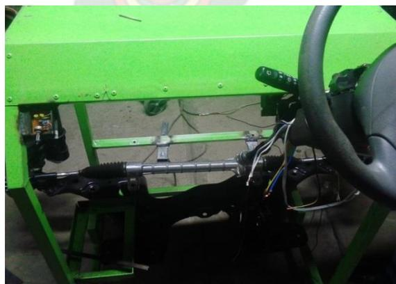
*Fig.52. Generador de pulsos para el funcionamiento dela dirección.*
