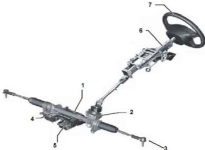
Fig. 26. Sistema de dirección electrónica EPS.
