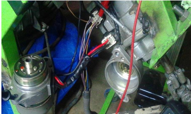
Fig.55. Cableado del sistema de dirección en el simulador EPS.
