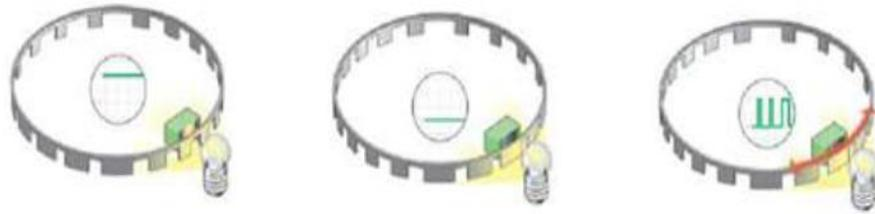
Fig. 30. Principio de funcionamiento del sensor de ángulo.
