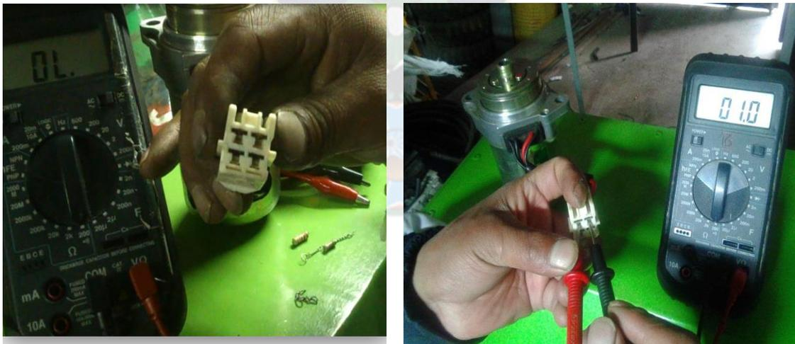
Fig.59. Prueba con la resistencia en B1 y B2 en ohmios del motor electrico según el manual.
