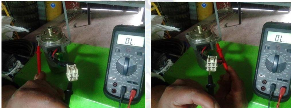
Fig.61. Continuidad entre el terminal del acoplador del motor y embrague y la tierra de la carrocería B1 y B3
