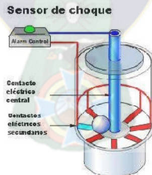
Fig. 13 Sensor de choque
