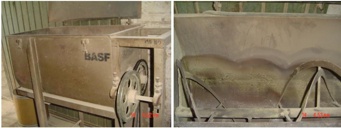
**Foto 20. Mezcladora horizontal con capacidad de 1.5 tn**
