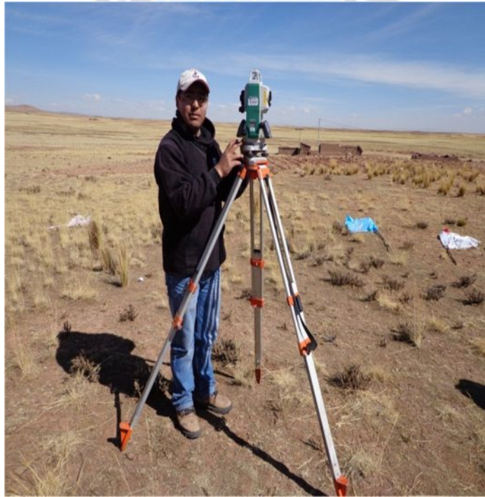
Fotografía N° 06: Levantamiento de puntos con equipo de estación total
