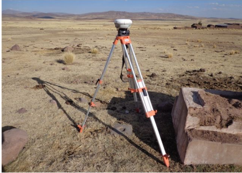
Fotografía N°03: Sesión de equipo L2 Sokkia en punto de control CM-321
