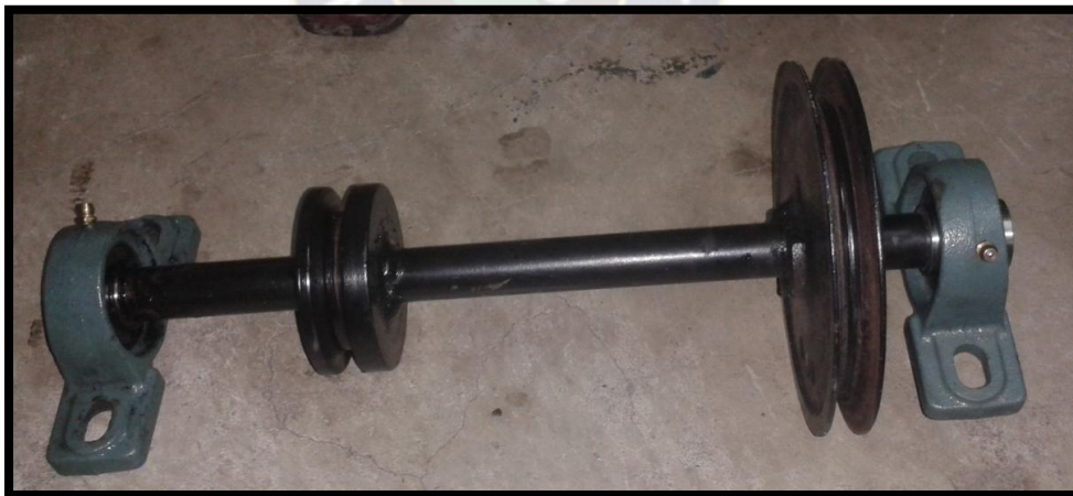
Figura 38. Mecanismo de poleas.
