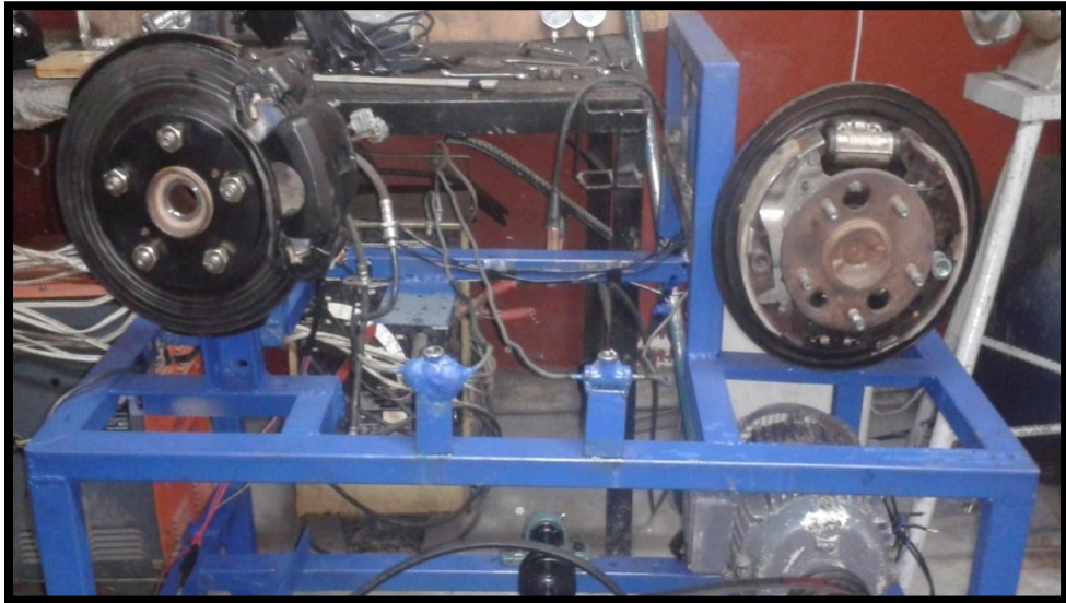
Figura 31. Ubicación de las ruedas en la estructura.
