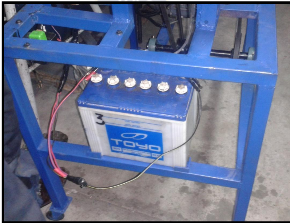
Figura 37. Ubicación de la batería.
